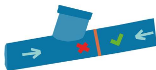
Installation de clapets anti-retour pour empêcher l'inondation d'entrer par les égouts
