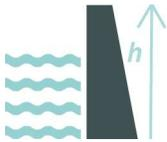
*On parle de grand barrage si la hauteur de sa voûte est supérieure à 20 m et sa capacité de rétention supérieure à 15 millions de m<sup>3</sup>.*
