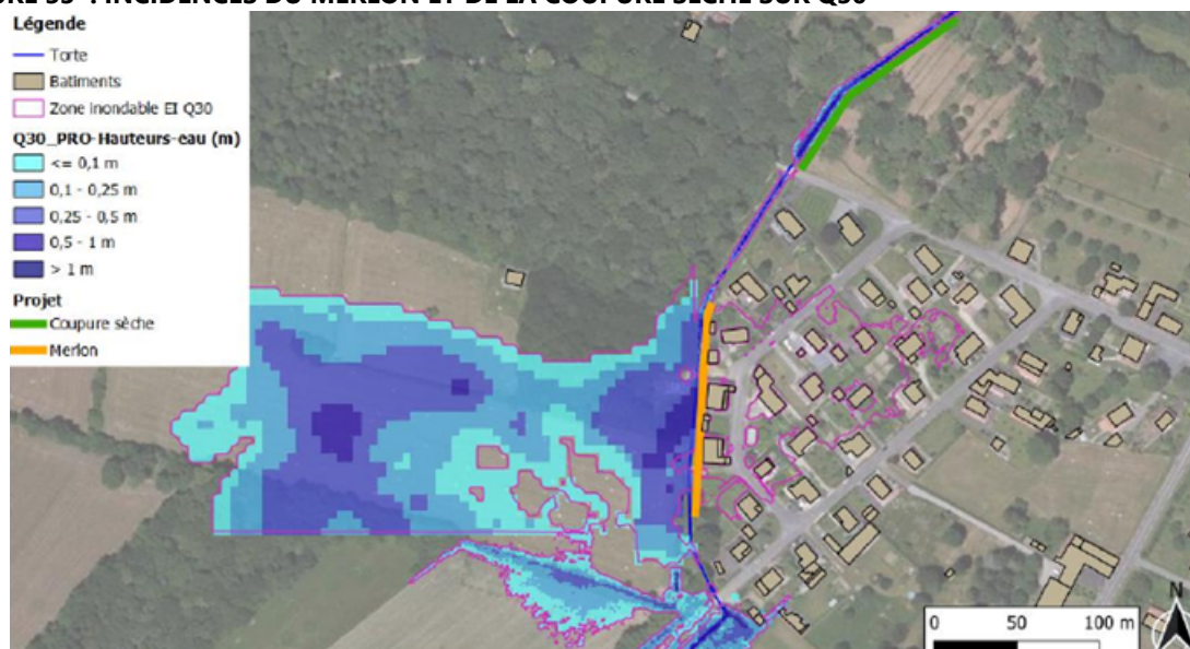
FIGURE 33 : INCIDENCES DU MERLON ET DE LA COUPURE SÈCHE SUR Q30
