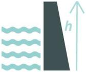
*On parle de grand barrage si la hauteur de sa voûte est supérieure à 20 m et sa capacité de rétention supérieure à 15 millions de m<sup>3</sup>.*
